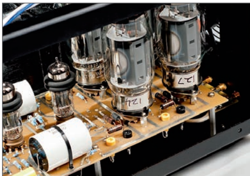
Cztery lampy Tung-Sol KT120 na kanał bez problemu zapewniają moc rzędu 150 W. Warto zwrócić uwagę na jakość płytki drukowanej
