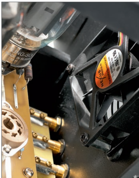
Wentylatory marki Nexus (dwa, oddzielnie po jednym dla każdego kanału) są bezszrotkowe i bardzo ciche. Dopiero na najszybszym biegu zaczynają duczą. Zmiany prędkości obrotowej dokonuje się ręcznie
