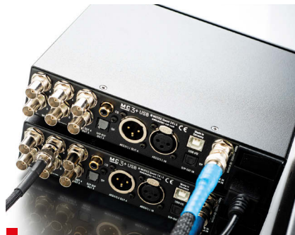
MC3+ ma 4 wyjścia zegarowe oraz cały zestaw wejść i wyjść audio.
