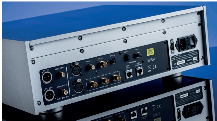
Tylny panel potrafi onieśmielić. Dolny rząd trzech gniazd BNC to wejścia i wyjście sygnału zegara.
